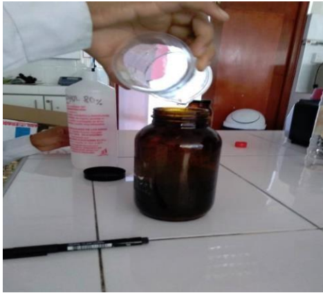
Macerado y filtración de la muestra
