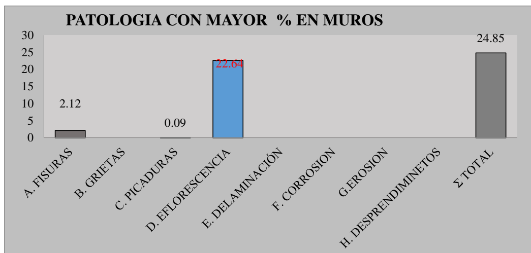
Gráfico 02: Porcentaje de patología en muros de la unidad de muestra 01
