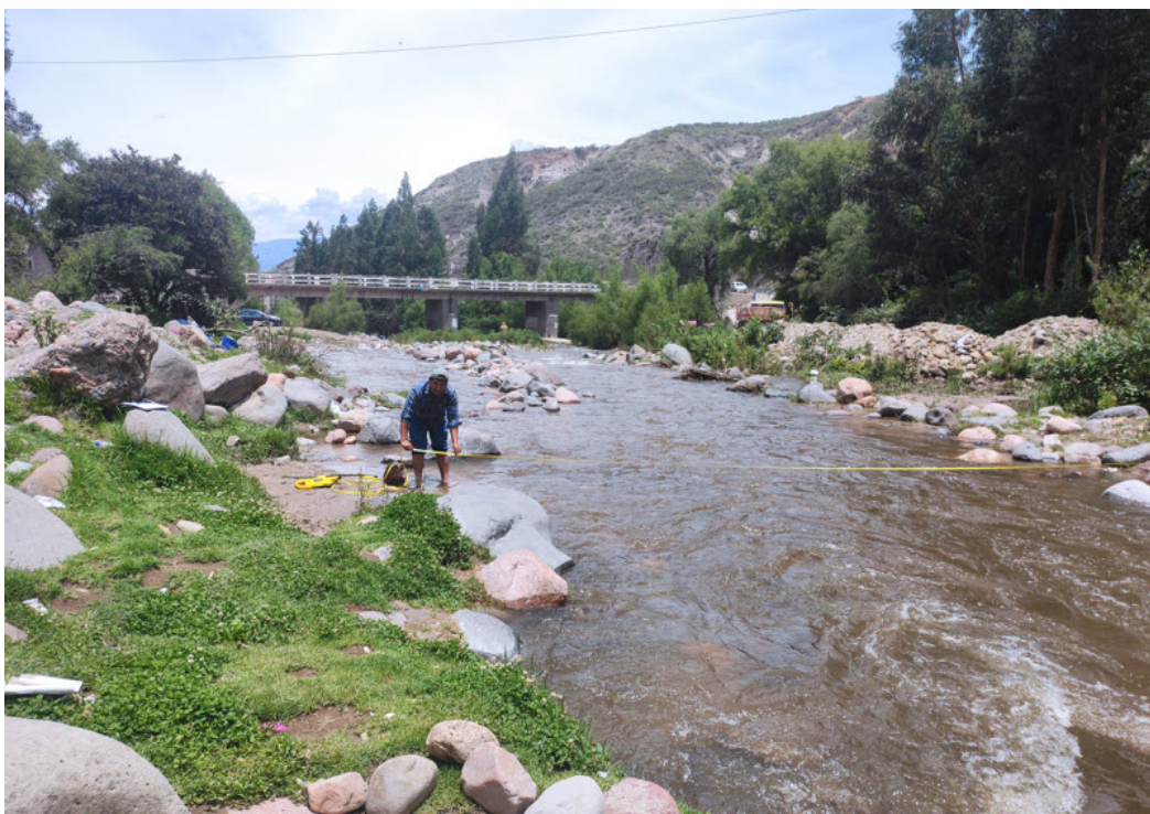
Fotografía 2: Midiendo ancho del río Huatatas.
