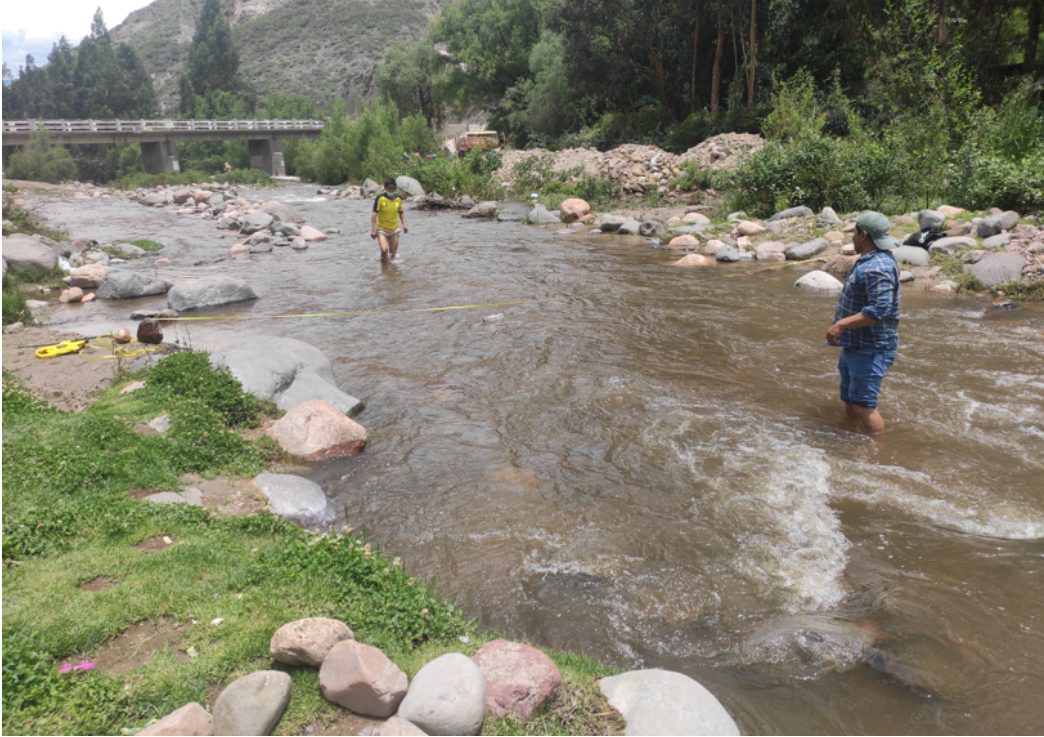
Figura 5.19: Medida de ancho del río Huatatas.
