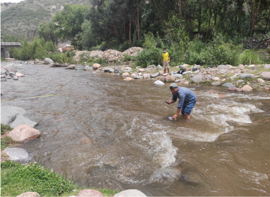
Fotografía 3: Midiendo la velocidad del río.
