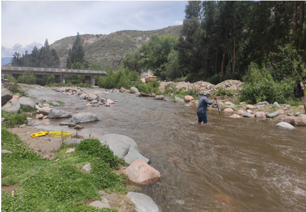
Fotografía 1: Midiendo la sección del ancho del río.
