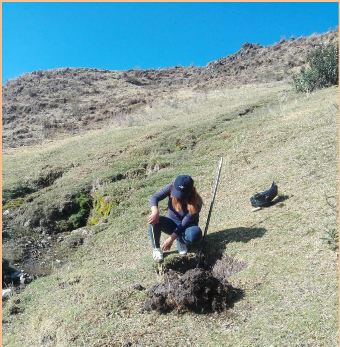
Imagen 05. Tomando medidas para la exploración de Calicata en la captación
