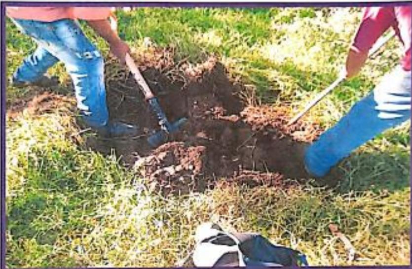
FOTO N° 83.- OBSERVAMOS UN PRIMER ESTRATO DE (SW) ARENA GRUESA BIEN GRADUADA, COMPACTADA, HUMEDA, DE POCA PLASTICIDAD, RICES Y GRAMA, PRESENCIA DE NIVEL FREÁTICO.
