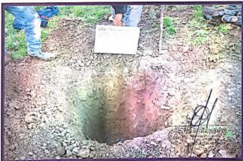
FOTO N° 02.- OBSERVAMOS UN SEGUNDO ESTRATO CONFORMADA POR GRAVAS MAL GRADUADAS (GP) CON ARENAS DE POCA PLASTICIDAD, COMPACTADA, CON PRESENCIA DE PARTICULAS DE DIÁMETRO NOMINAL 1" - 6" DE FORMA ANGULOSA NO HAY PRESENCIA DE NIVEL FREÁTICO.
