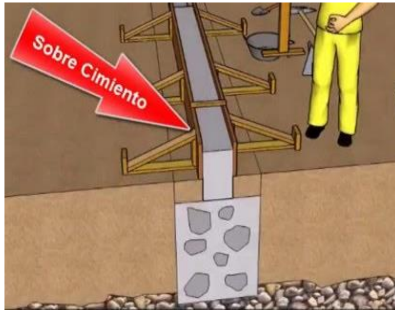
Imagen 12: Sobrecimiento de concreto armado
