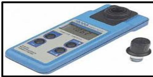
Figura 4: Turbidímetro
