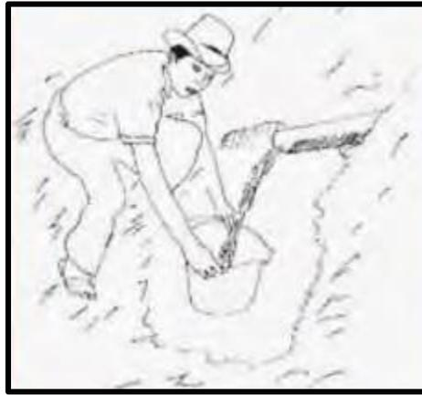
Figura 16: Método volumétrico
