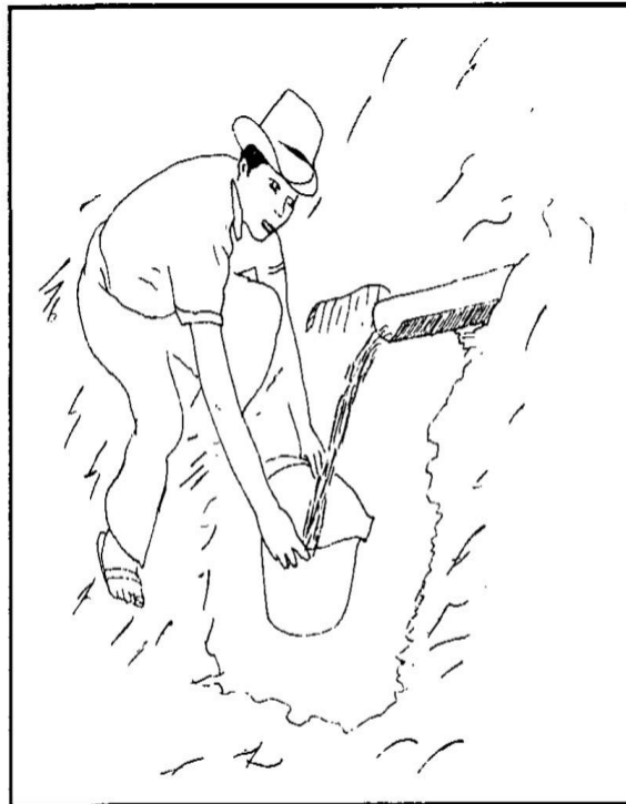
Figura 1: Aforo de agua por método volumétrico
