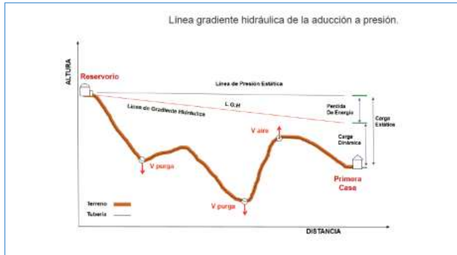
imagen 11 Línea de aducción
