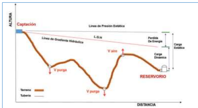
imagen 8 Línea de conducción por gravedad
