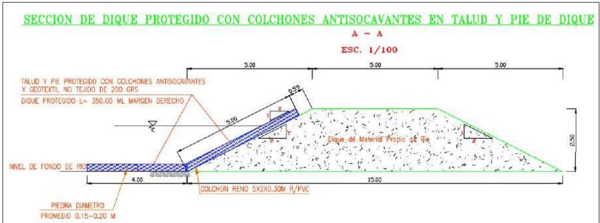
Gráfico 25: Sección de dique protegido
