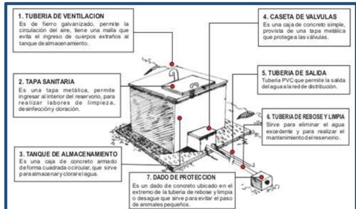
**Figura 13:** Partes del reservorio.
