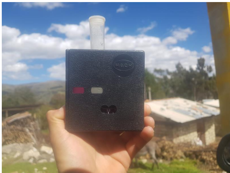
Fotografía 8. Instrumento para la medición de cloro residual
