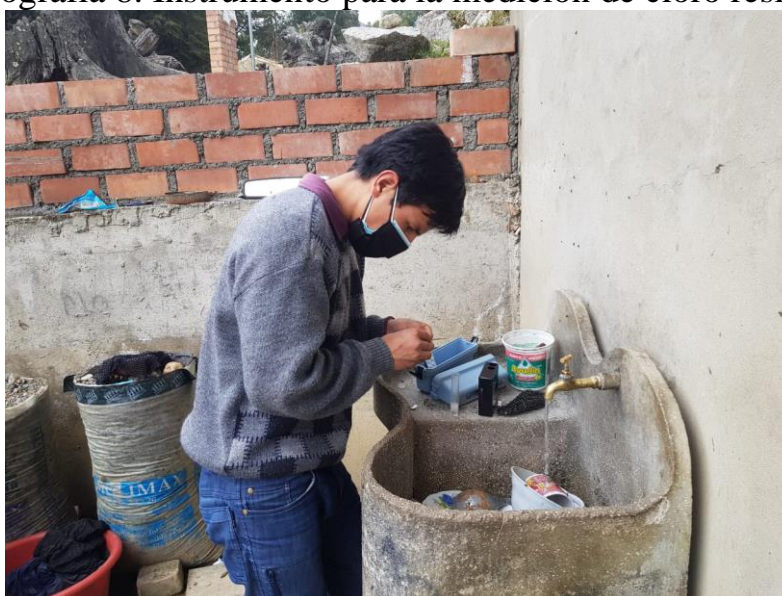
Fotografía 9. Realizando la medición de cloro residual
