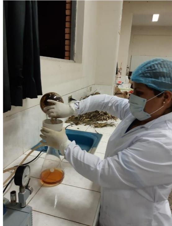
**Figura 06.** Se añadirán a cada frasco etanol-agua (7:3) cantidad suficiente hasta cubrir la muestra por sobre 2 cm de altura. Se mezclará bien, teniendo en cuenta que la mezcla debe ocupar como máximo las  $\frac{3}{4}$  partes del recipiente. Se tapanán los recipientes y se macerarán por 7 días, agitándose 15 minutos, dos veces al día.
