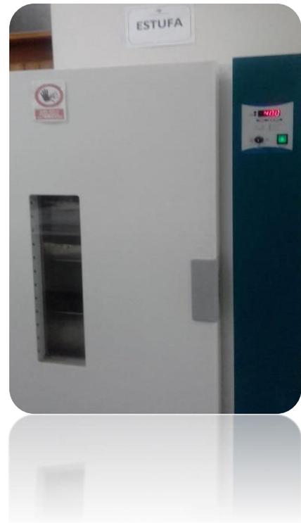
**Figura 02.** Ambas muestras vegetales serán colocadas por separado en papeles Kraft, y se llevarán a secar a una estufa de circulación de aire por convección forzada (40 C) por 48 horas.
