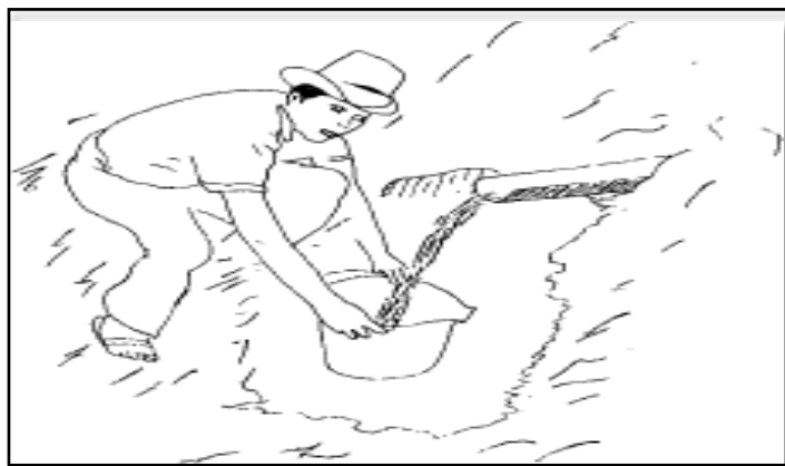
Figura 1: Aforo del agua por el método volumétrico.
