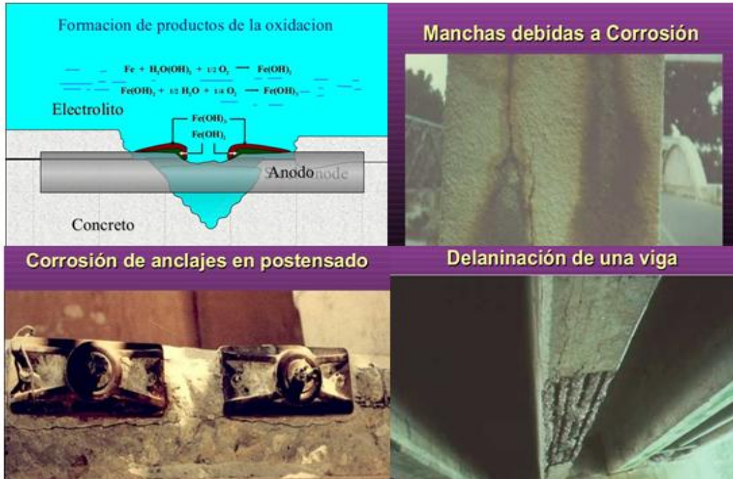
Imagen 23. Corrosión del Concreto por Ataques Químicos.
