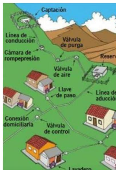
**Figura 4:** Sistema Abastecimiento de agua potable
