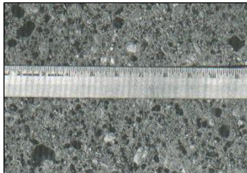
Ilustración 31-1. Pulimento de agregados.
