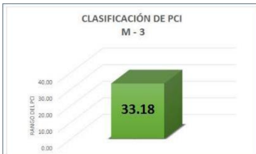
Figura 61: Índice de condición del pavimento Unidad de Muestra 3
