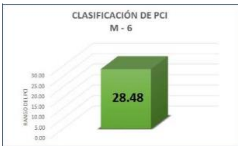
Figura 91: Índice de condición del pavimento Unidad de Muestra 6
