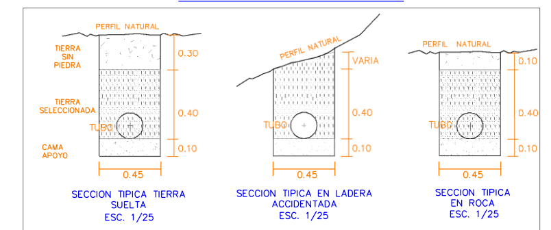
TIPO EXCAVACIONES PARA TUBERIA
