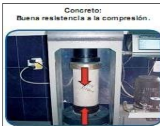
Figura 02: Resistencia a la compresión
