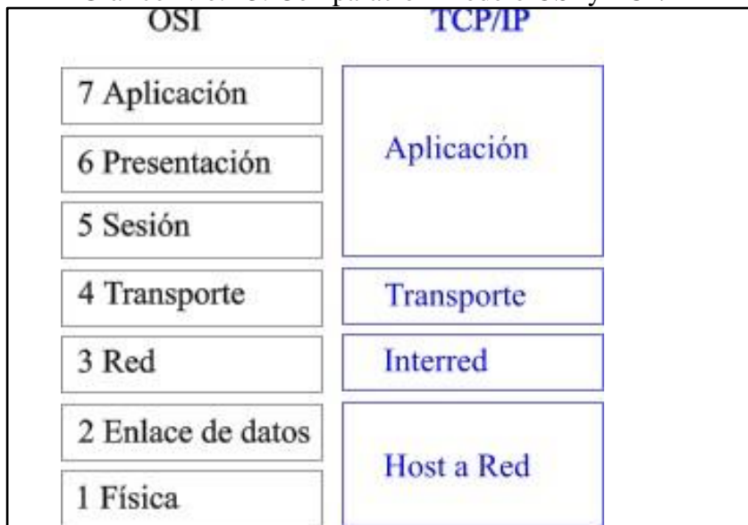
Gráfico Nro. 13: Comparación Modelo OSI y TCP/IP
