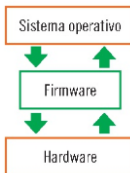
Gráfico Nro. 5: Comunicación del firmware con el hardware y software.
