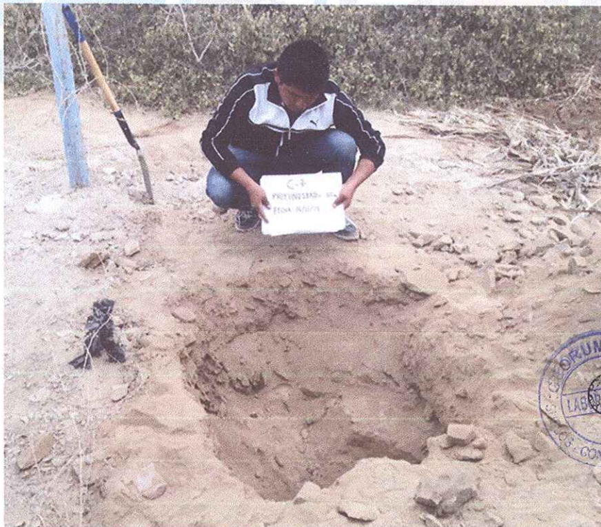
Foto N° 08.- Se aprecia una vista general del lugar donde se excavo 0.50m para la calicata C-07.
