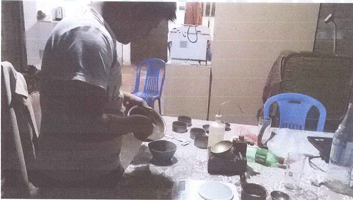
Foto N° 12.- Se aprecia colocando material pasante del tamiz N° 40 en un recipiente, posterior a ello se aplicara una cantidad de agua, para iniciar la determinación del límite líquido del suelo.
