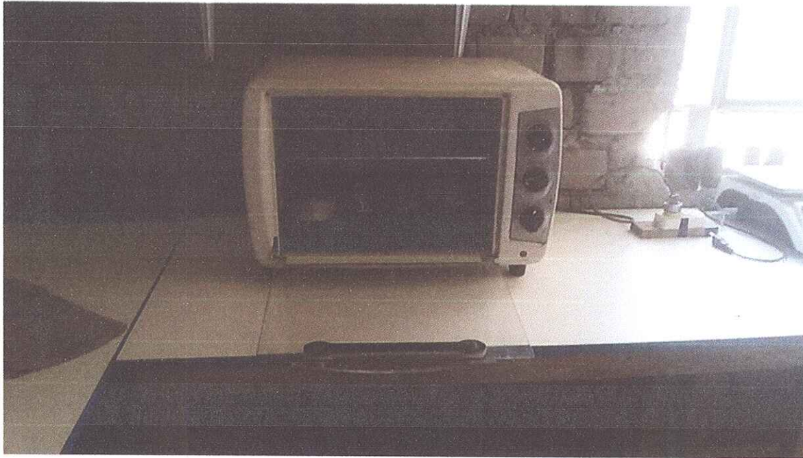
Foto N° 15.- Se aprecia las muestras de suelos dentro del horno para realizar el secado de dichas muestras para determinar el contenido de humedad.
