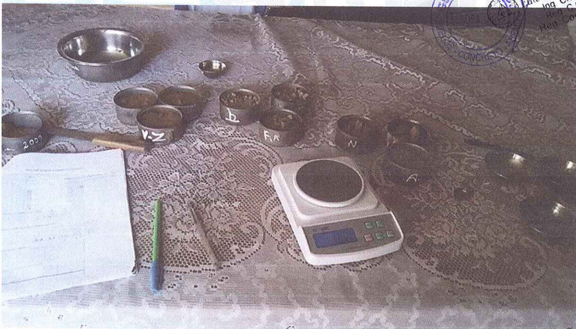
Foto N° 14.- Se aprecia 9 muestras representativas, de las cuales se obtuvieron 3 muestras por calicata para realizar el ensayo de contenido de humedad.
