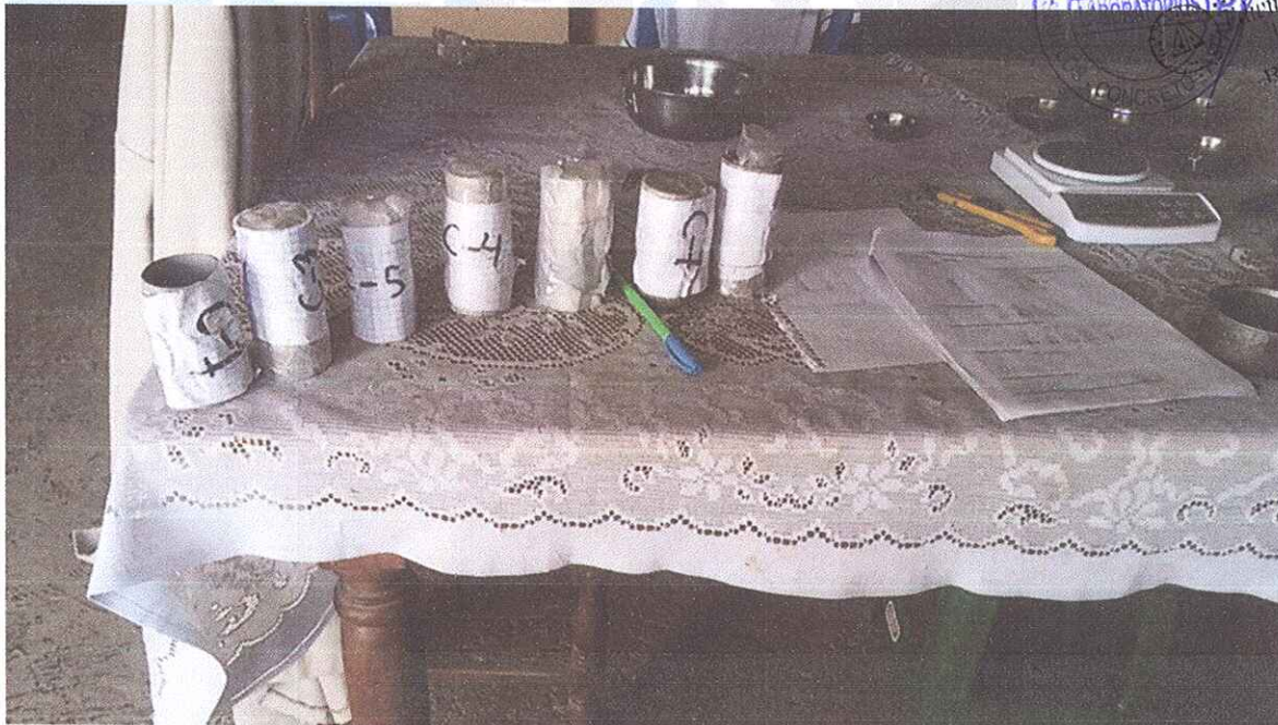
Foto N° 16.- Se aprecia las muestras de suelo obtenidos de las diferentes calicatas en pequeños contenedores (tubos metálicos), para poder determinar la densidad natural de cada calicata.
