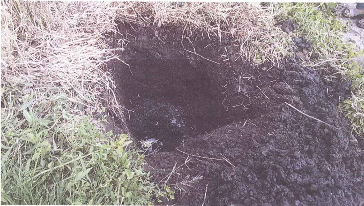
Foto N° 07.- Se aprecia el perfil estratigráfico de la calicata C-06 y presencia de nivel freático a 1m de profundidad.
