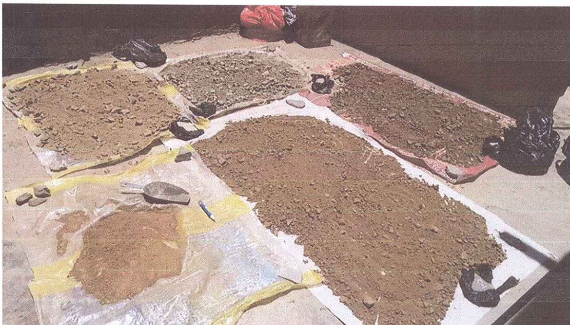
Foto N° 09.- Se aprecian las muestras de suelo obtenidos de las diferentes calicatas.
