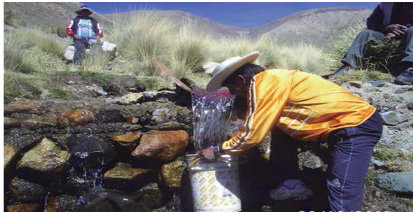
Figura. 4.- Aforo del agua por el método volumétrico Nota. Fuente: García, J. (2013)
