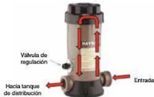
Ilustración N° 03.58. Dosificador por erosión de tableta
