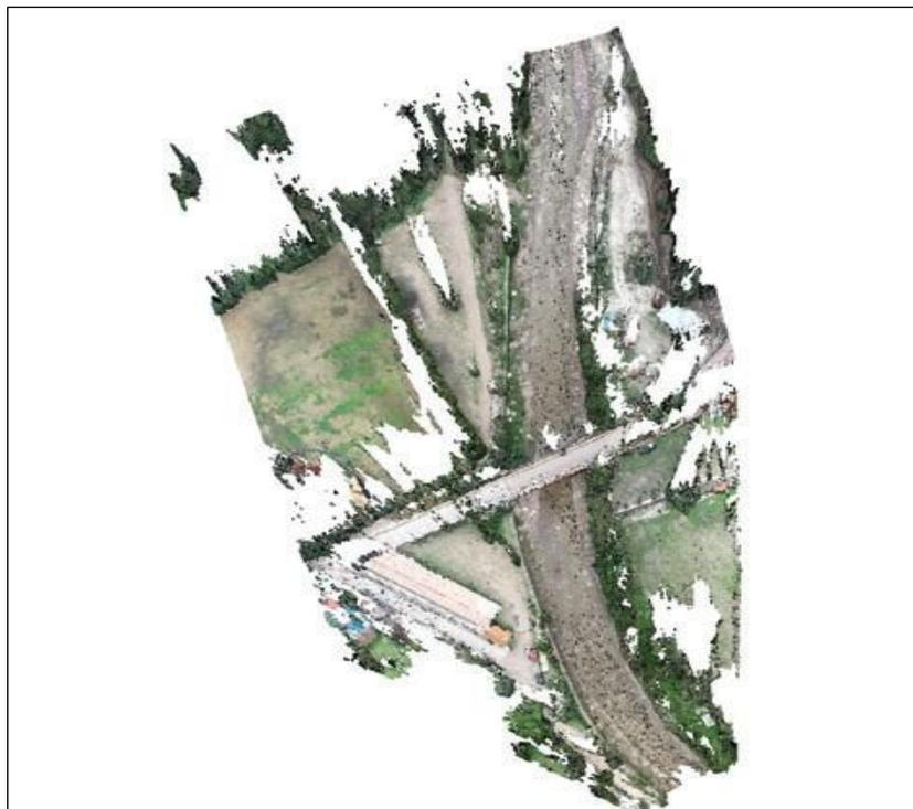
**Figura N°20.** Modelo de nube de puntos denso
