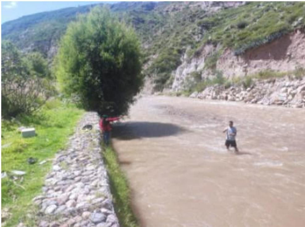
**Figura N°32.** Cálculo de caudal con objeto flotante.
