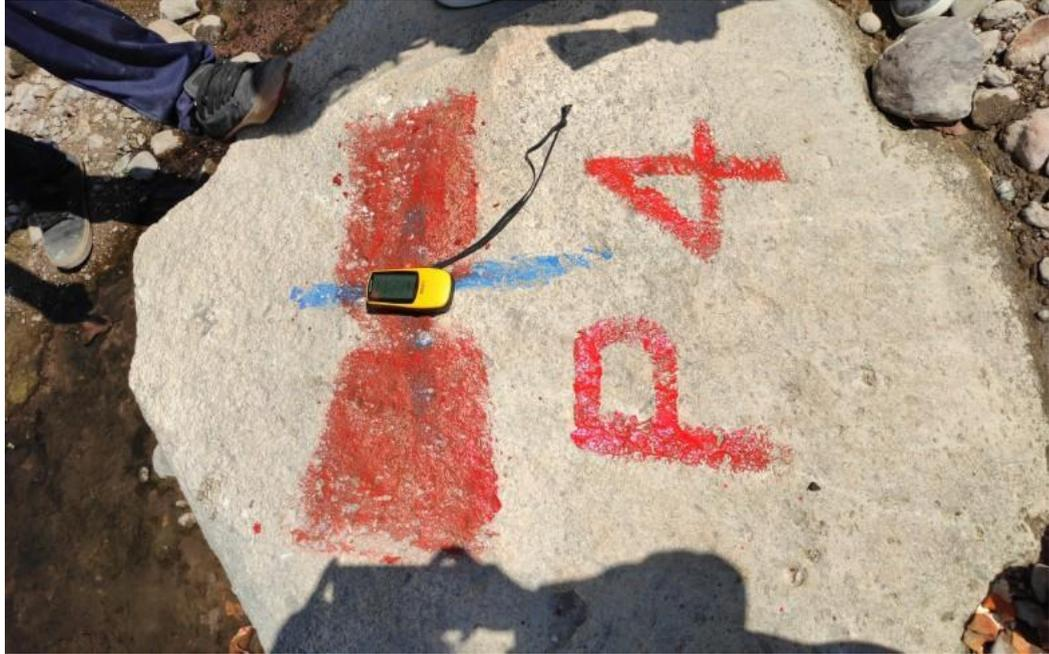
***Figura N°17.*** Ubicación de los puntos de control tomados
