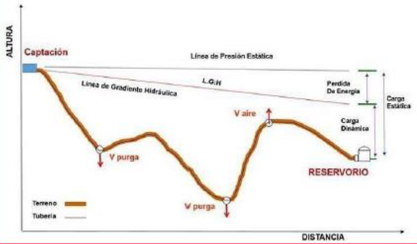
Ilustración N° 03.31. Línea de Conducción
