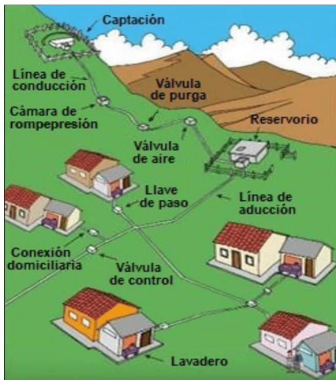
Imagen 03: Sistema de abastecimiento del agua potable
