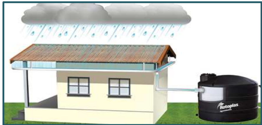
Figura 8. Captación de agua pluvial en vivienda.
