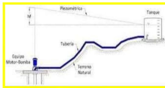
Figura 15. Conducción por bombeo
