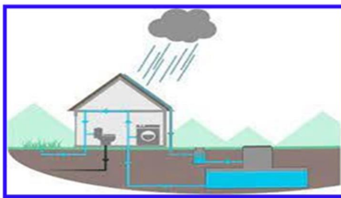
Figura 8. Esquema de captación de agua pluvial en una vivienda
