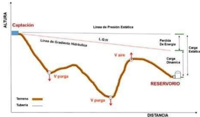
Ilustración N° 03.31. Línea de Conducción
