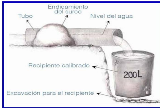
Figura 4. Esquema de medición del caudal por el método volumétrico
