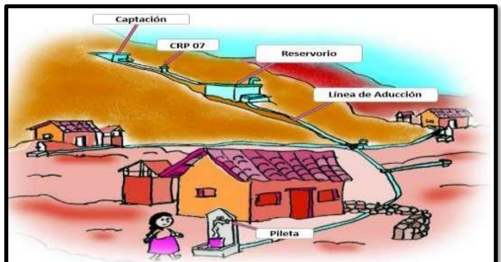
Figura 4: Línea de Conducción.
