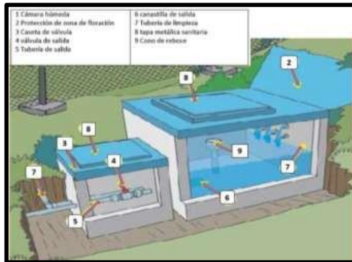
Figura 2: Captación de tipo ladera.
