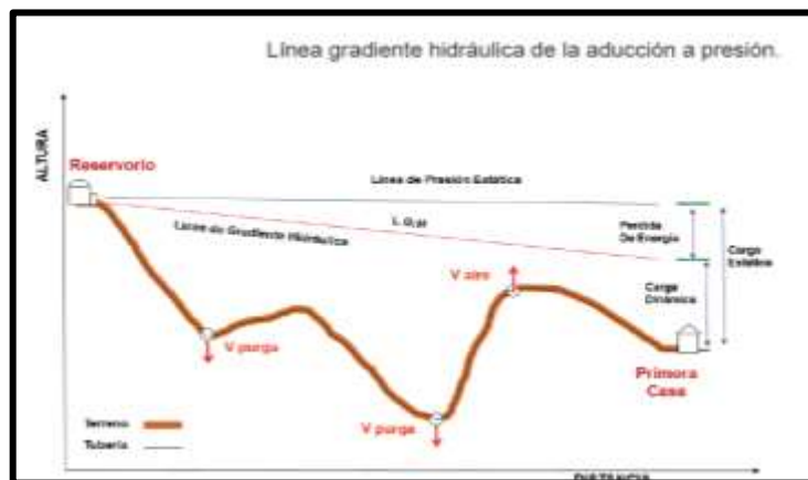
Imagen 13: Línea de aducción
