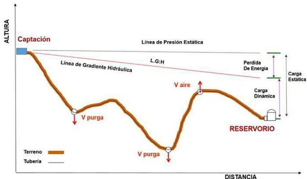
Ilustración N° 03.31. Línea de Conducción
