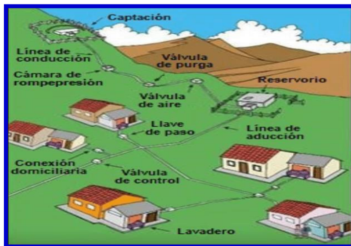
Figura 1: Sistema de abastecimiento de agua potable.
