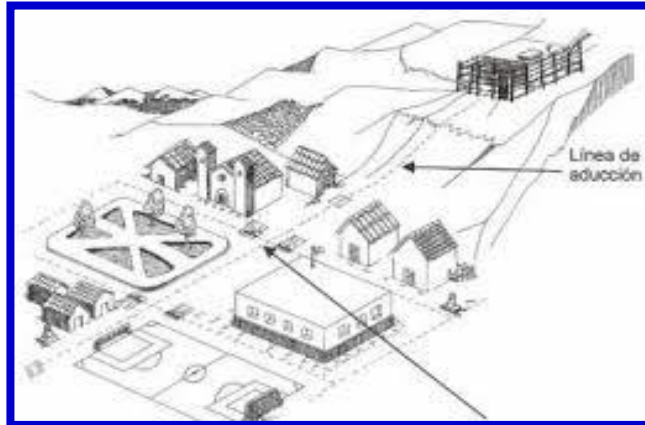
Figura 17: Esquema de una línea de aducción Fuente: Saneamiento básico
