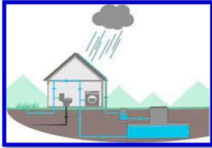
Figura 2: Captación de agua pluvial en vivienda
