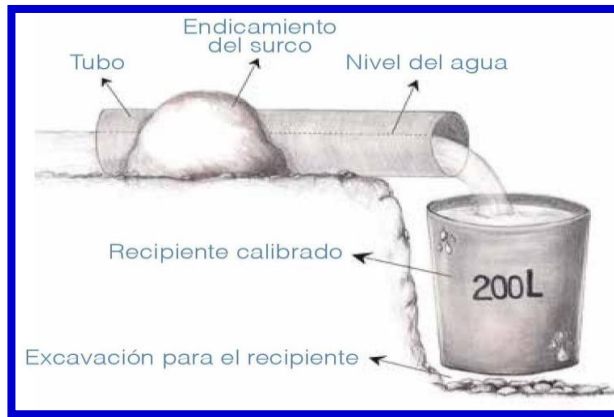
Figura 5: Medición del caudal por el método volumétrico Fuente: Mediciones de caudales/métodos
