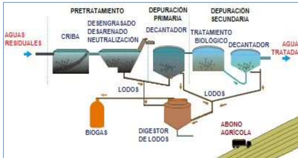
Figura N° 4. Planta de tratamiento de aguas residuales.
