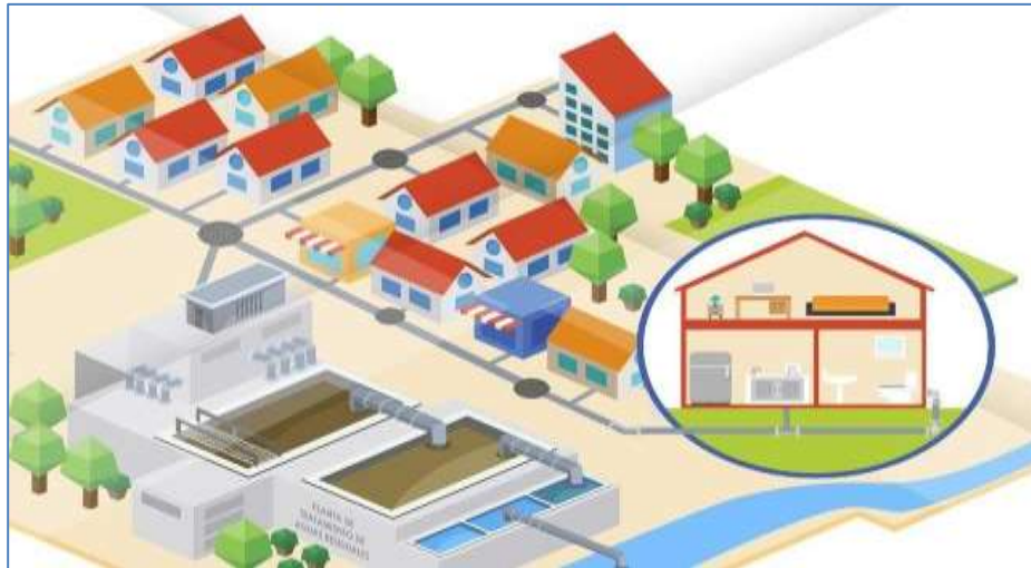
Figura N° 1. Sistema de alcantarillado sanitario.
