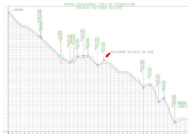
Figura 26: mejoramiento de la línea de conducción
