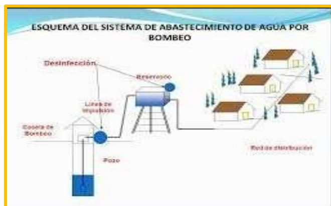
Figura 6: Sistema de agua potable por bombeo
