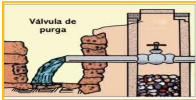
Figura 11: Válvula de purga
