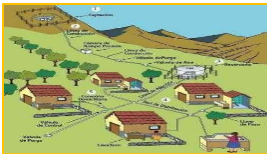
Figura 3 : Sistema de abastecimiento de agua potable
