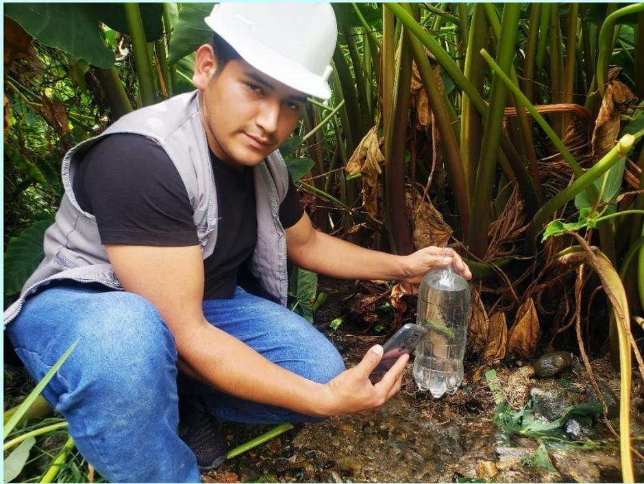
**Imagen 03:** Se aprecia la toma de muestra de agua del manantial para enviarlo al laboratorio.
