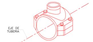
ISOMETRICO ABRAZADERA DOS CUERPOS TERMOPLÁSTICOS
