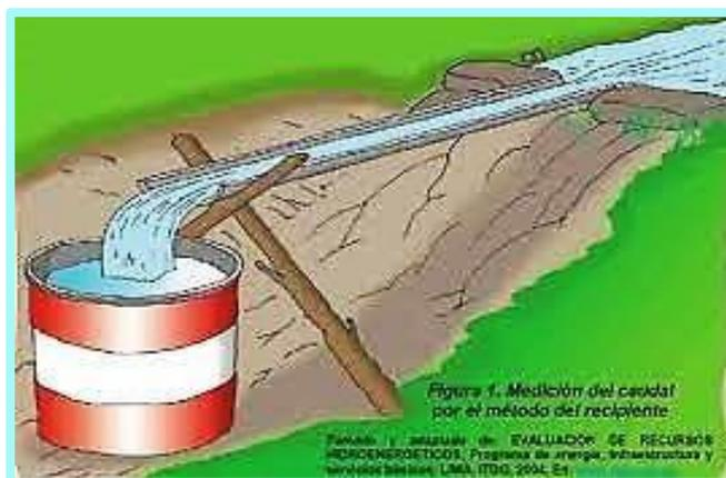
**Gráfico 2. Medición por el método volumétrico**
