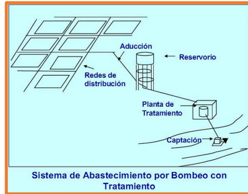
Figura 14. Sistema por bombeo con tratamiento.
