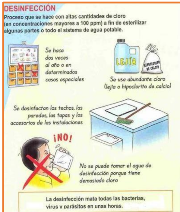
Figura 29. Proceso de desinfección del agua.
