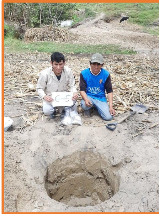
Imagen 21. Calicata N° 05, en el reservorio a 132.92 m.s.n.m.
