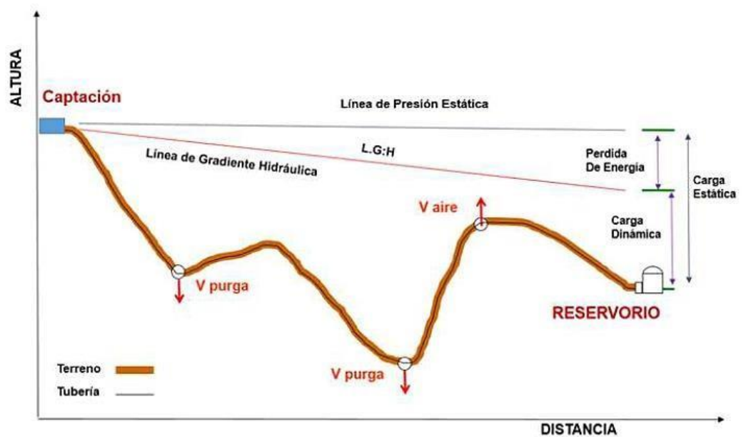
Ilustración N° 03.31. Línea de Conducción
