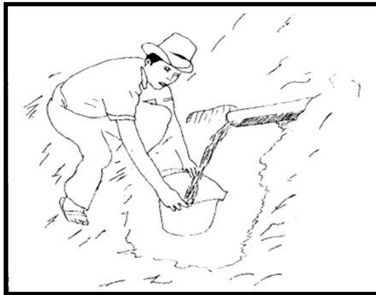
Figure 5 Aforo de agua por método volumétrico
