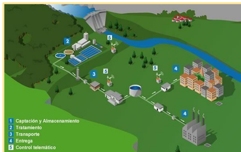
Figura 1: Sistema de abastecimiento de agua potable
