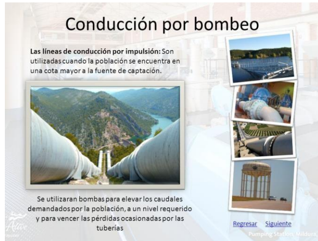
Figura 11: Conducción por bombeo
