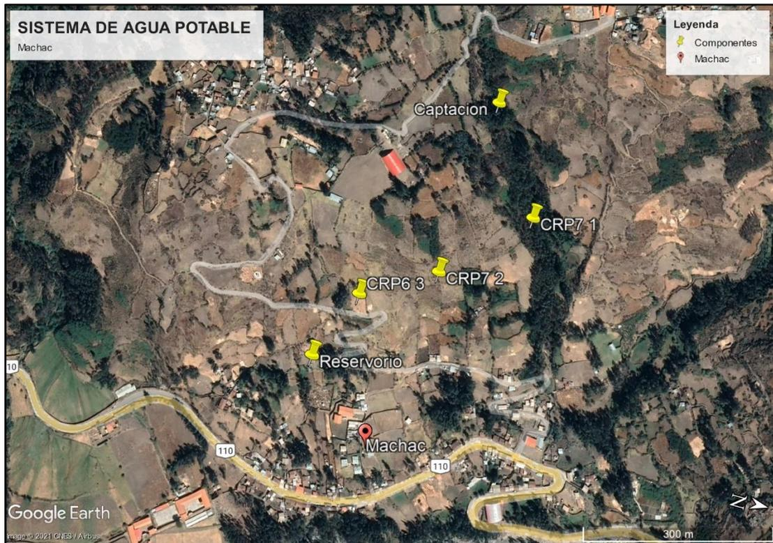
Foto 01: Esquema del sistema de agua potable
