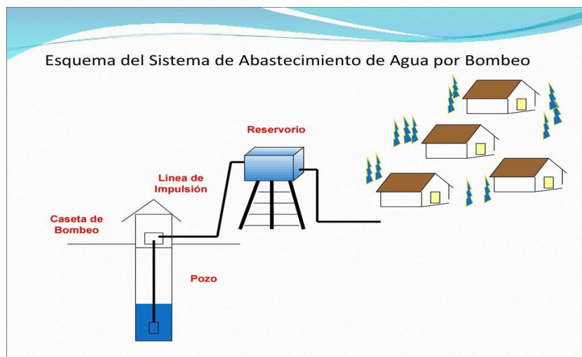
Figura 7. Sistema de agua por bombeo
