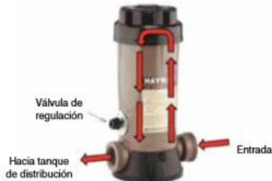
Ilustración N° 03.58. Dosificador por erosión de tableta
