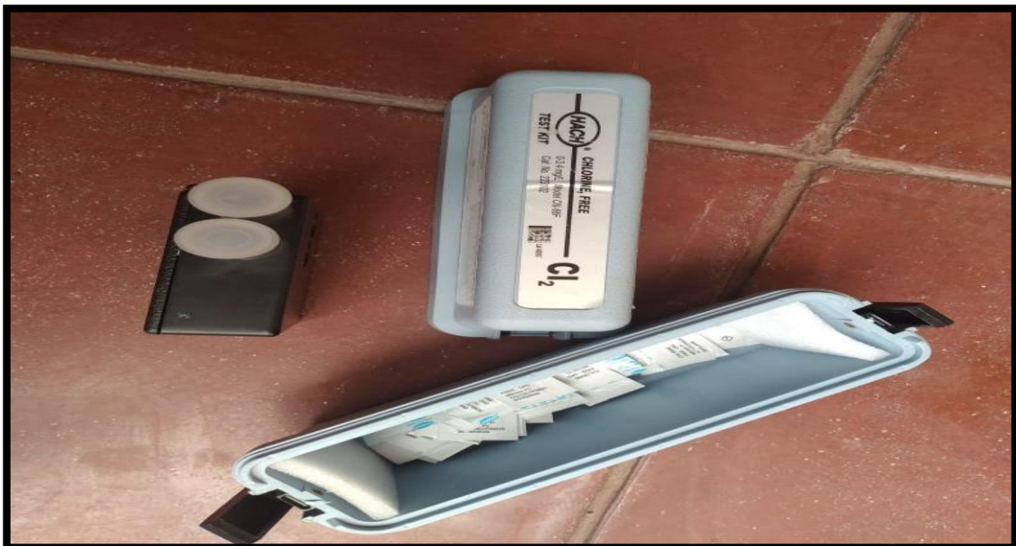
Fotografía 07: Test Quit para ver la presencia de cloro residual en el sistema.
