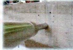
**CORRELACIÓN ENTRE LA RESISTENCIA AL REBOTE - RESISTENCIA A COMPRESIÓN**
