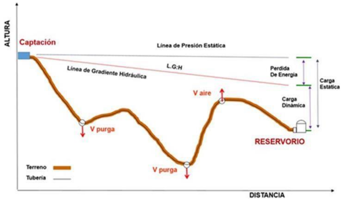
Figura 1 : línea de conducción
