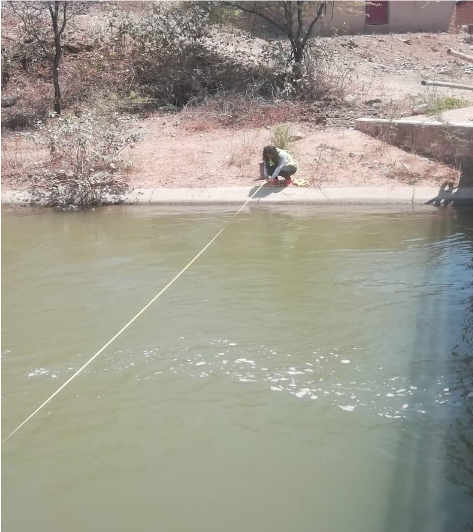
Foto 03. Midiendo el ancho del canal Tablazo, cuya caja hidráulica es de 10.80 m de base mayor, la base menor de 3.20 m/seg. Una altura de 2.40 m, con una velocidad de 1.79 m/seg. El caudal es de 30 \text{m}^3/\text{seg} .
