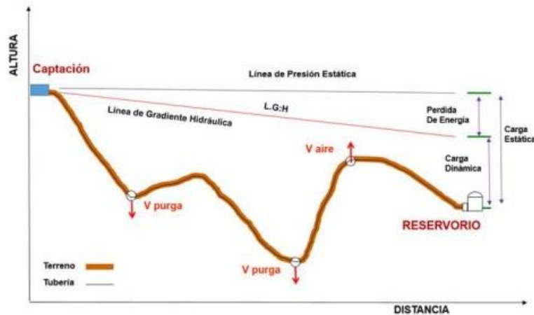
Ilustración N° 03.31. Línea de Conducción
