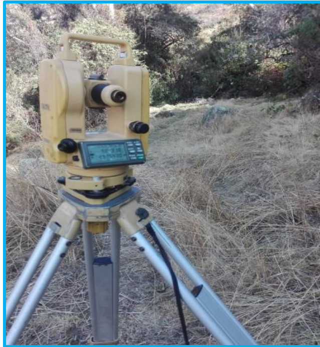
Figura 16: Vista del teodolito para dar inicio al levantamiento topográfico.
