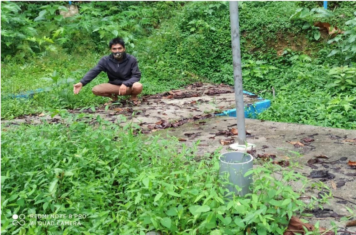
**Figura 8:** Calculo del caudal de la fuente – Método volumétrico
