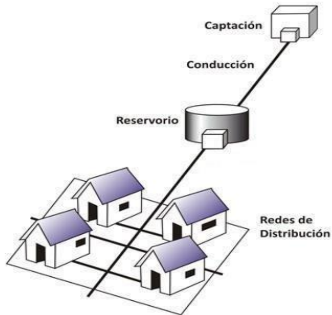
Figura 7. Sistema de abastecimiento de agua potable
